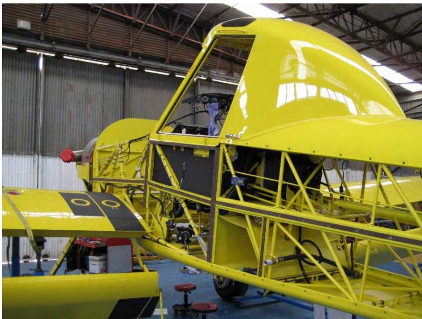
Air Tractor AT-504 - в процесі збирання
