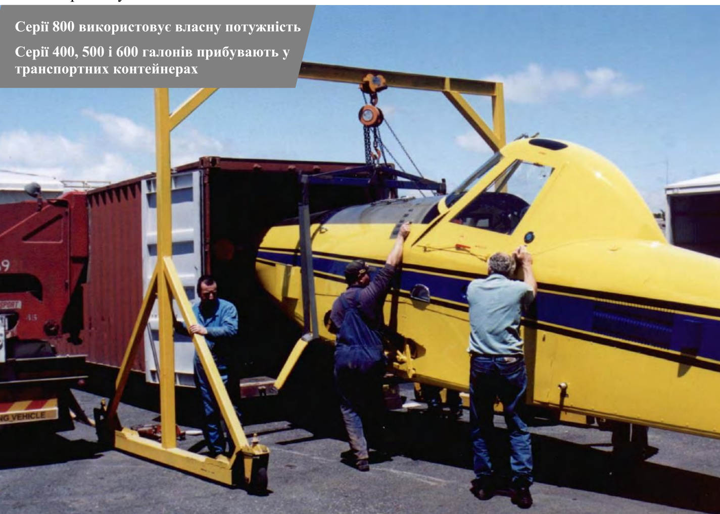
Air Tractor AT-602 зі знятими крилами виймається з контейнера для транспортування перед повторним складанням.
